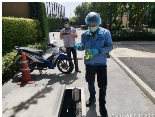
ภาพที่ 3.5.3-1 การเก็บตัวอย่างน้ำของระบบน้ำใช้
